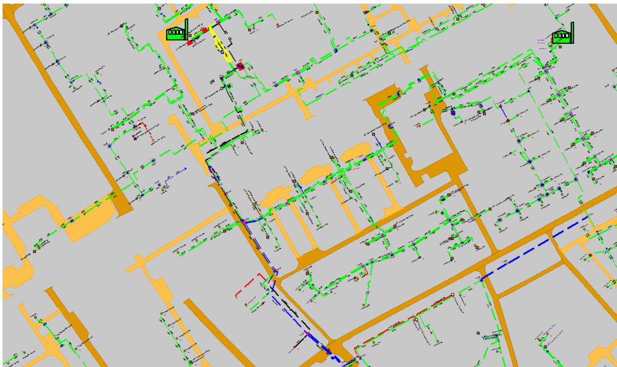
Рисунок 1.187 Результат гидравлического расчета - расчетный путь теплоносителя от котельной Баренца, 9а до ПТ-Иван.55а
