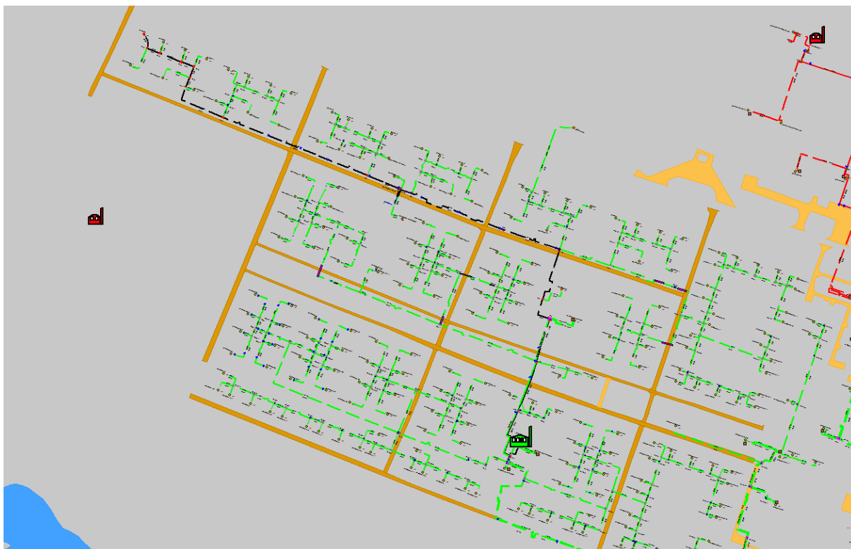
Рисунок 1.189 Результат гидравлического расчета - расчетный путь теплоносителя от котельной Планетная, 8а до ПТ-Ясная,24
