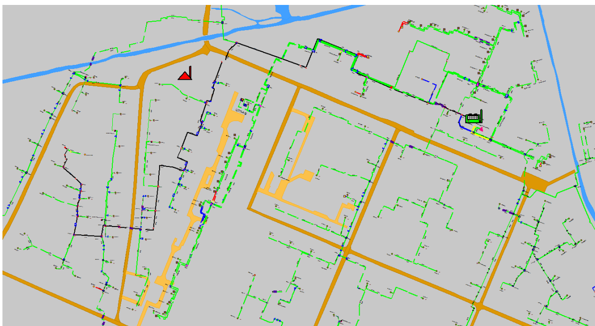
Рисунок 1.109 Результат гидравлического расчета - расчетный путь теплоносителя от котельной Премудрова, 12а до ПТ-Гвозд,8
