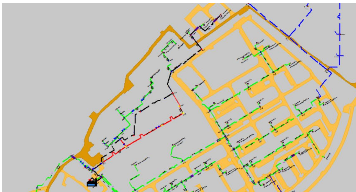
Рисунок 1.163 Результат гидравлического расчета - расчетный путь теплоносителя от котельной Цветочная, 3-а до ПТ-Цветочная,7/2
