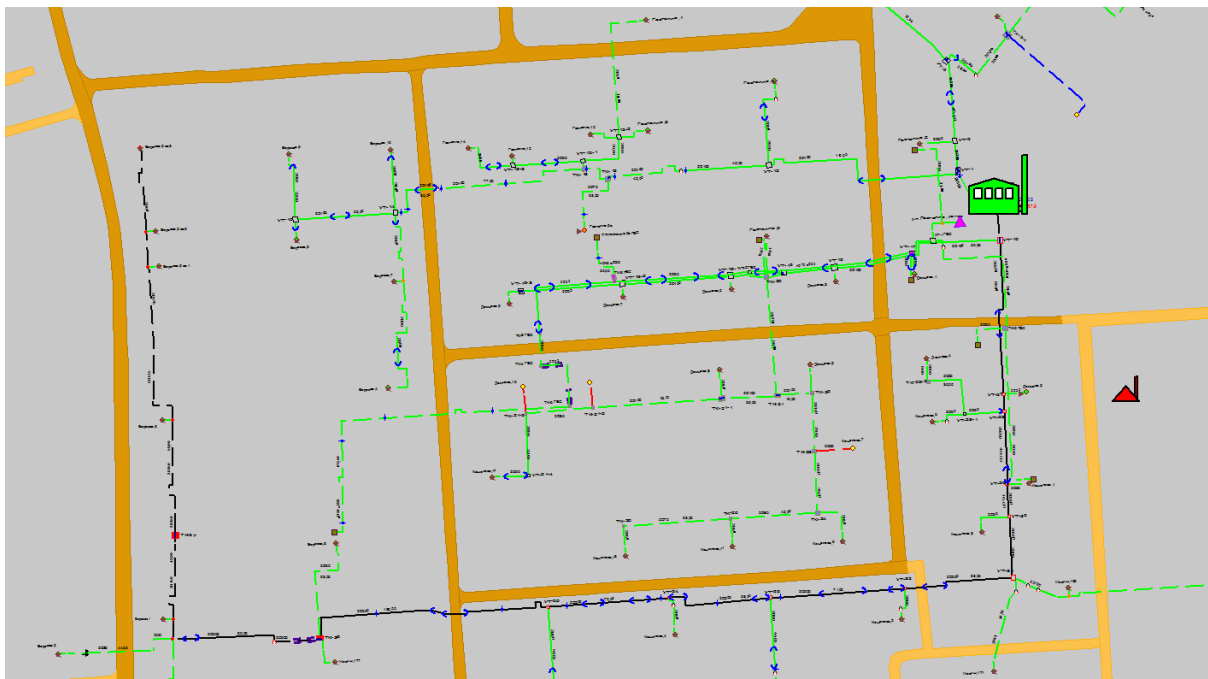
Рисунок 1.137 Результат гидравлического расчета - расчетный путь теплоносителя от котельной Гастелло, 1-а до ПТ-Березов,5 вв3
