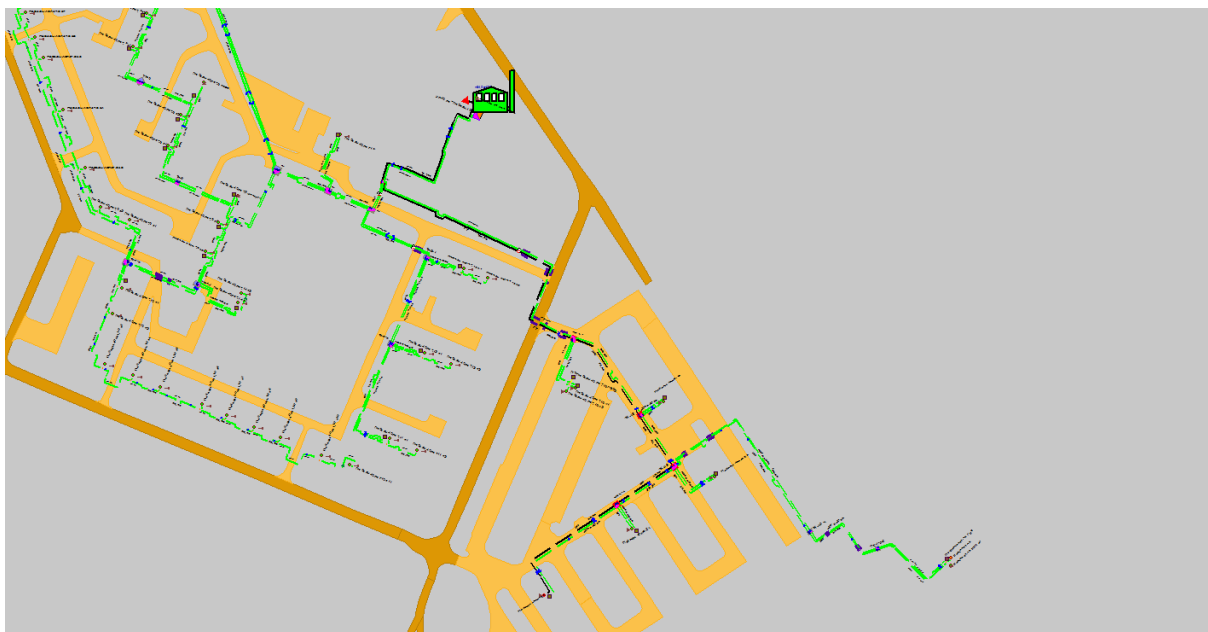
Рисунок 1.161 Результат гидравлического расчета - расчетный путь теплоносителя от котельной 40 лет Победы, 15 до ПТ-Победы 40лет,22
