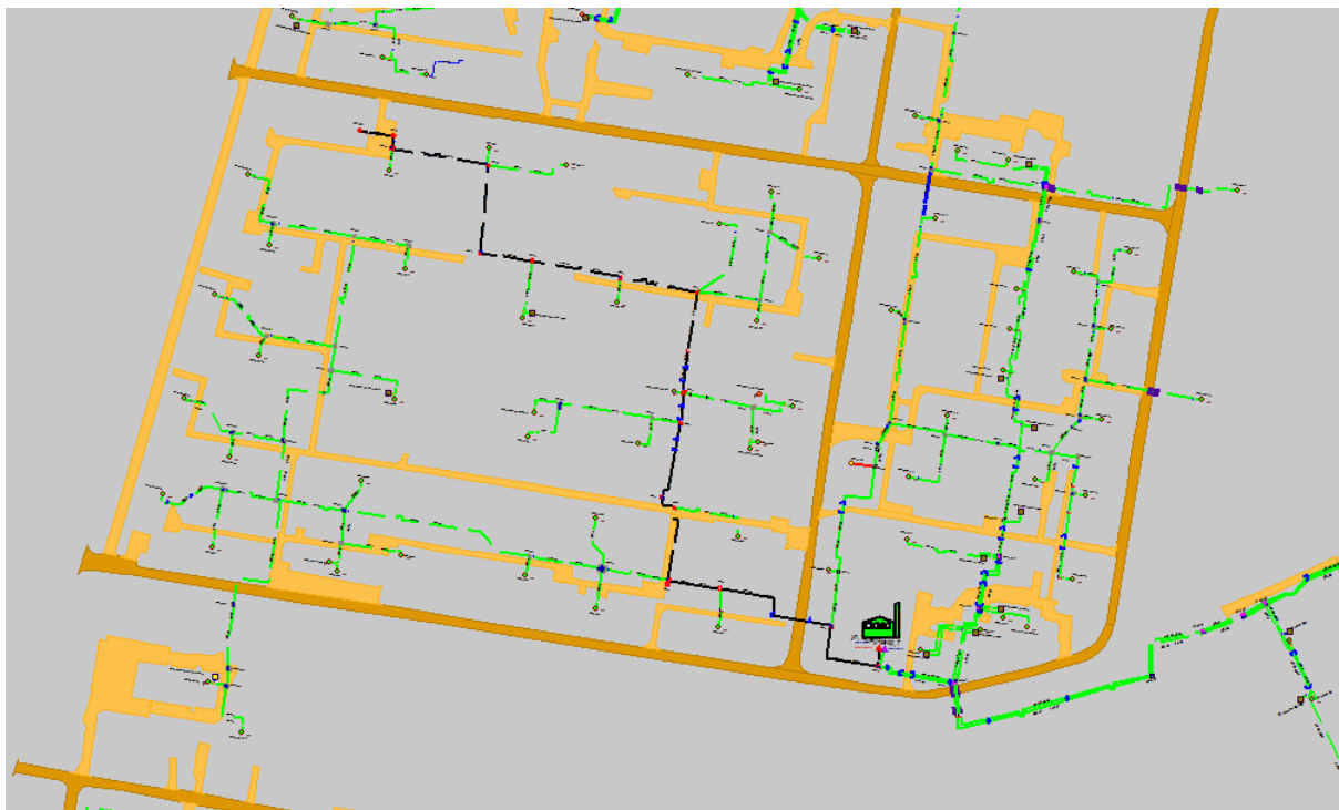
Рисунок 1.215 Результат гидравлического расчета - расчетный путь теплоносителя от котельной Терешковой, 7 до ПТ-Сурик,2
