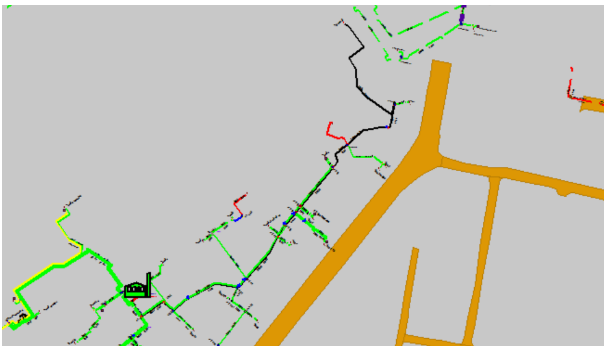
Рисунок 1.91 Результат гидравлического расчета - расчетный путь теплоносителя от котельной Чкалова, 9д до ПТ-Революц.пл,2
