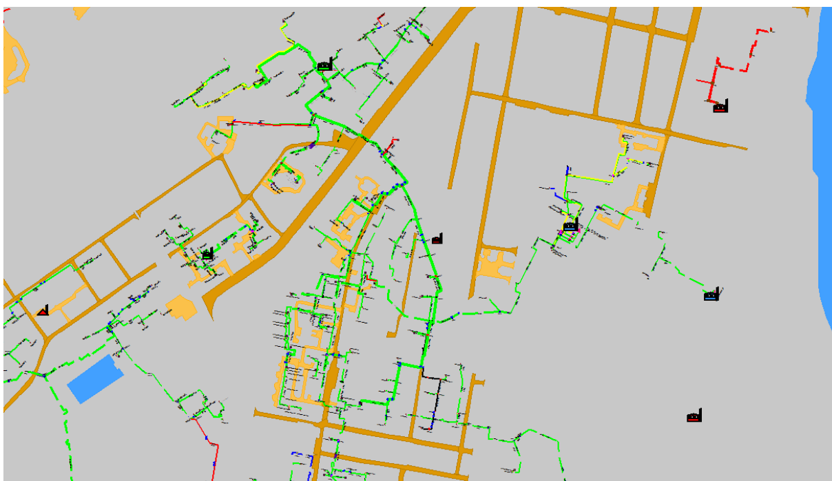
Рисунок 1.93 Результат гидравлического расчета - расчетный путь теплоносителя от котельной Чкалова, 9д до ПТ-Вольск,8
