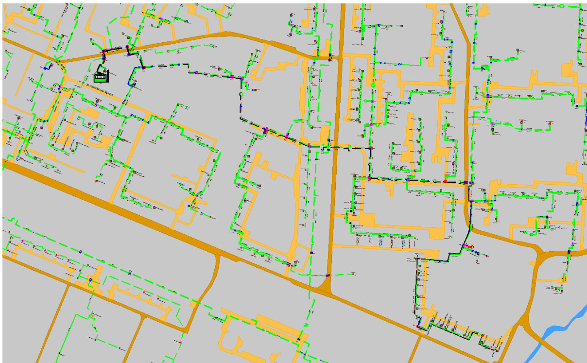
Рисунок 1.127 Результат гидравлического расчета - расчетный путь теплоносителя от котельной Академика Баха, 4-а до ПТ-Макар, 18 э2
