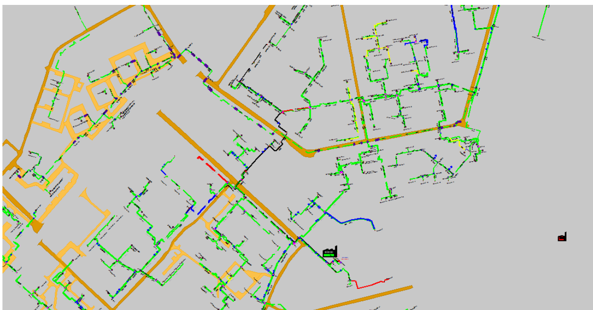
Рисунок 1.151 Результат гидравлического расчета - расчетный путь теплоносителя от котельной ул. Голованова, 25-а до ПТ-Гагар.пр,184 э2
