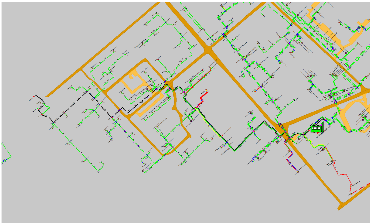
Рисунок 1.61 Результат гидравлического расчета - расчетный путь теплоносителя от котельной пр. Союзный, 43 до ПТ-Замкнут,15 э3
